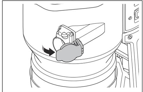
2. Coloque o adaptador da mangueira no conector.
