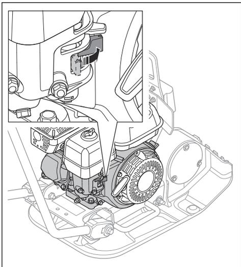
2. Coloque o acelerador na posição de 1/3 de aceleração.
