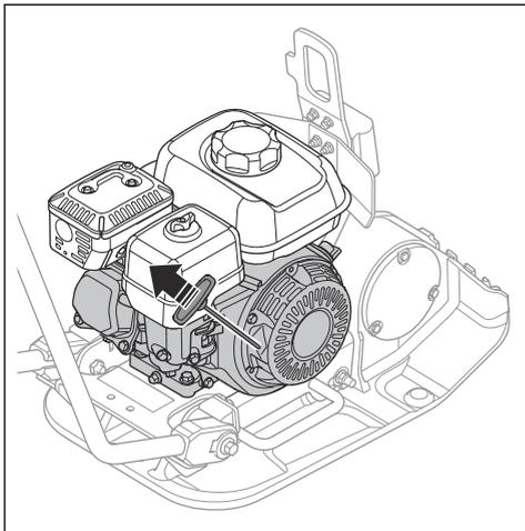
6. Solte o punho do cabo de arranque para deixar o cabo de arranque recolher.
