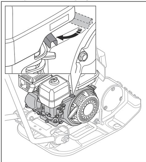
2. Coloque o interruptor ON/OFF na posição "OFF". O motor para.
