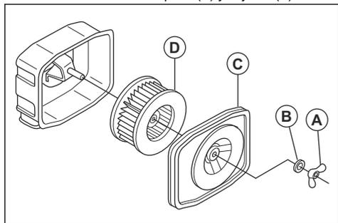
2. Retire la cubierta del filtro de aire (C).
