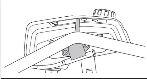
2. Tire de la empuñadura de la cuerda de arranque lentamente hasta que note resistencia.
