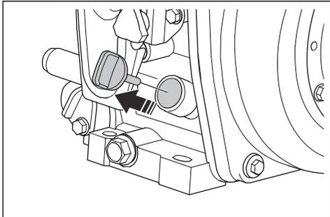
4. Vuelva a colocar la varilla de nivel totalmente en el interior del depósito de aceite.
