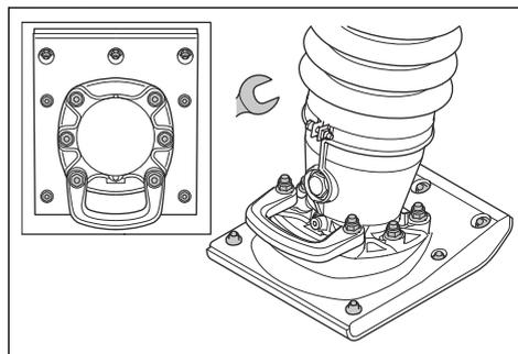
**Nota:** Una zapata del pistón de 280 mm/11 pulg. de ancho tiene 13 pernos. Una zapata del pistón de 330 mm/13 pulg. de ancho tiene 19 pernos.
