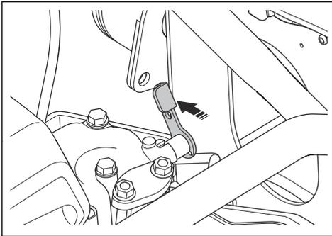
**Nota:** La palanca de descompresión vuelve a su posición inicial cuando arranca el motor.
