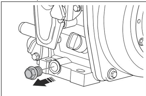
3. Conecte una manguera al orificio de drenaje de aceite.
