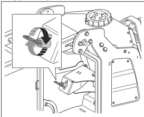
3. Tire del acelerador y gírello al régimen de ralentí del motor. Consulte *Rpm del motor en la página 39.*
