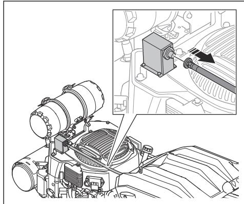
3. Retire el servo de control de velocidad y las cubiertas de limpieza del cilindro.
