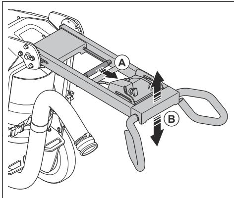
2. Ajuste el mango (B) una altura de funcionamiento adecuada.
