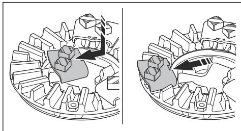
13. Coloque la placa de herramientas recta (A) en el disco de desbaste.
