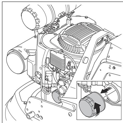
3. Lubrifier légèrement le joint en caoutchouc du filtre à huile neuf avec de l'huile neuve.
