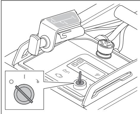
6. Tourner l'interrupteur principal dans le sens inverse des aiguilles d'une montre.
