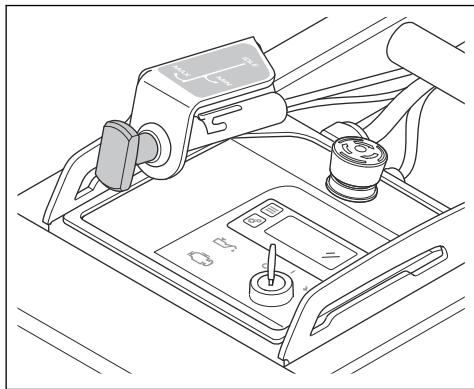
3. Empuje el producto hacia delante sobre la superficie del piso. Utilice el acelerador para ajustar la velocidad entre "MÍN." y "MÁX." mientras opera el producto.
