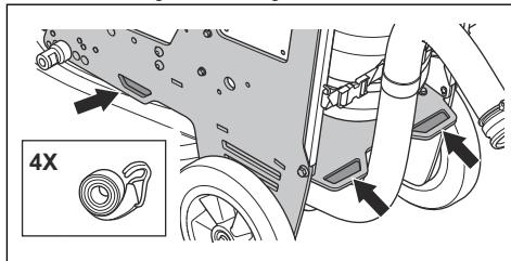
3. Fixer et serrer les sangles d'arrimage sur le véhicule.
