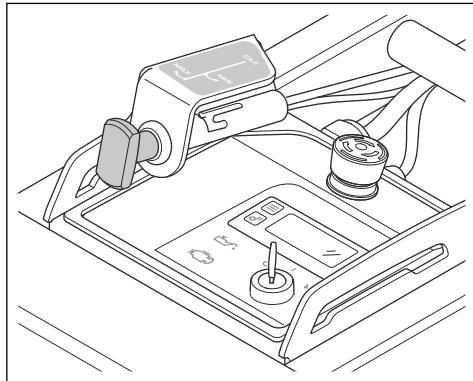
3. Pousser le produit vers l'avant sur la surface du sol. Utiliser la commande d'accélération pour régler le régime entre « MIN » et « MAX » pendant l'utilisation du produit.
