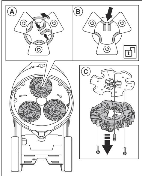
10. Tire de la placa de herramientas hacia afuera (C) para quitar la placa de la herramienta del disco de desbaste.
