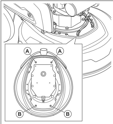
2. Conecte las mangueras de agua (A) a los racores acodados (B) si desplaza la conexión de la alimentación de agua trasera a la delantera.
