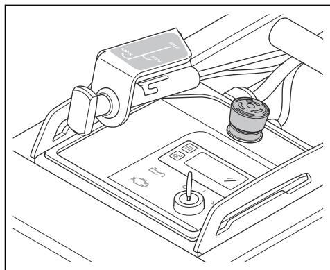
**MISE EN GARDE :** Ne pas utiliser le bouton d'arrêt d'urgence comme bouton d'arrêt du produit. Ne pas utiliser le bouton d'arrêt d'urgence de la machine pour arrêter le produit, sauf en cas d'urgence.
