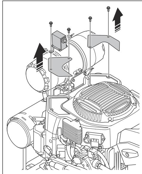
4. Limpie las aletas de refrigeración del cilindro con un cepillo o con aire comprimido.
