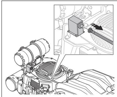
3. Retirer la servocommande de vitesse et les couvercles de nettoyage du cylindre.
