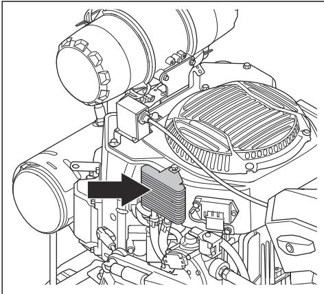
2. Retire el cable de control de velocidad.
