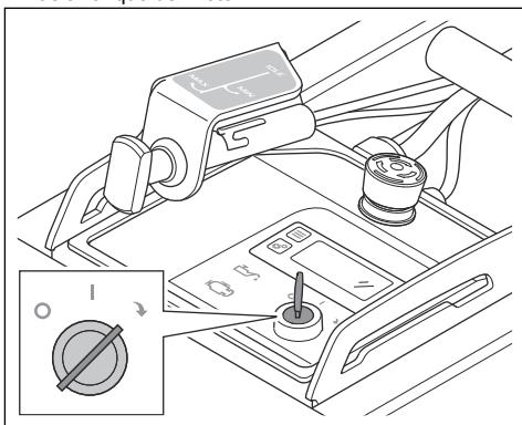
5. Cuando el motor arranque, suelte inmediatamente la llave de encendido. La llave de encendido se coloca en la posición "1".
