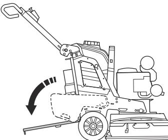
6. Asegúrese de que la tapa del depósito de agua está completamente cerrada antes de inclinar el producto.
