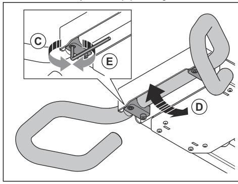
5. Régler le guidon (D) à une hauteur adéquate pour l'utilisation du produit.
