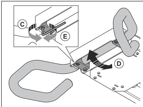
5. Ajuste el manillar (D) a una altura de funcionamiento adecuada.
