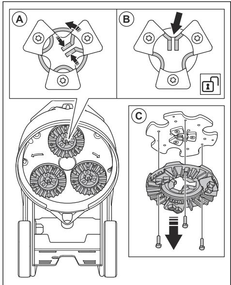
10. Tirer la plaque porte-outil en ligne droite vers l'extérieur (C) pour la retirer du disque à meuler.
