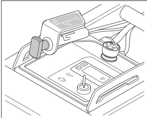
2. Tourner la soupape du réservoir de propane dans le sens des aiguilles d'une montre jusqu'à ce qu'elle s'arrête pour couper l'alimentation en propane du moteur.
