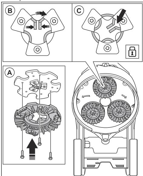
14. Serrer les pattes centrales l'une contre l'autre et tourner dans le sens horaire (B) pour verrouiller la plaque porte-outil du disque à meuler (C).
