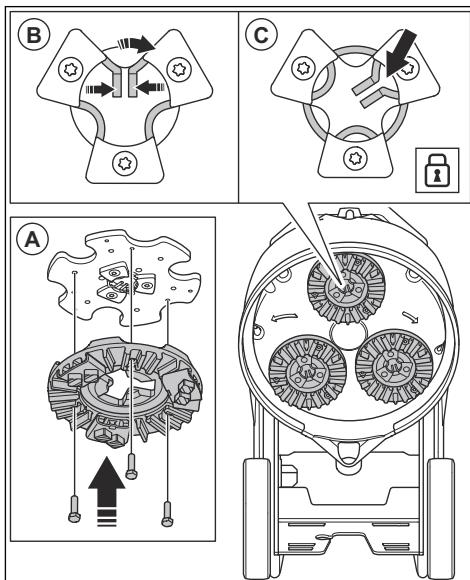
14. Junte las pestañas centrales y gírelas hacia la derecha (B) para fijar la placa de la herramienta al disco de desbaste (C).
