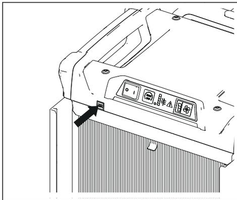
5. エアフローの LED インジケータは、必須フィルターの状態を示します。コントロールパネル A 45 の LED インジケータ 64 ページを参照してください。
