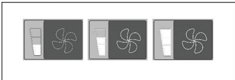
4. 按风扇的 Start/Stop [启动/停止] 按钮可启停风扇运行。有关位置信息，请参见 *控制面板的功能 (A 45)* 在第 33 页上。
