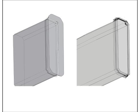
2. 用 4 个锁紧衬套将 Longopac 集尘袋和转接环安装在 出气口板上。
