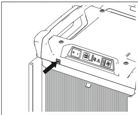
5. 气流 LED 指示灯表示基本过滤器的状态。请参阅 *控制面板 A 45 上的 LED 指示灯* 在第 40 页上。
