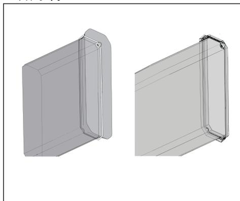
2. 4個のロックブッシングで、空気吹き出しロプレートに Longopac 集塵バッグとアダプターリングを取り付けます。
