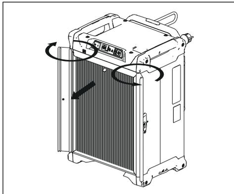
5. 逆の順序で、新品の必須フィルターを取り付けます。
