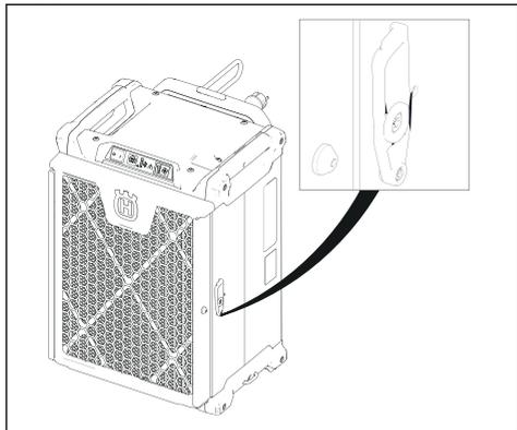
4. フィルターホルダーを開き、必須フィルターを取り外します。
