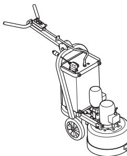
Les machines de surfaces de sol Husqvarna PG 530 ont été développées pour le polissage du marbre, du terrazzo, du granit et du ciment. Leur domaine d'applications va du broyage grossier au polissage de finition. La machine est conçue pour un usage commercial léger, par exemple dans les habitations, les garages et les petits commerces.
