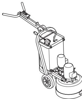
Las máquinas para preparar superficies Husqvarna PG 530 se han diseñado para el desbastado en seco o en mojado de mármol, terrazo, granito y cemento. Sus aplicaciones abarcan desde un desbastado basto hasta un acabado completamente pulido. La máquina se ha diseñado para uso comercial ligero, por ejemplo, viviendas, garajes y pequeños espacios comerciales.
