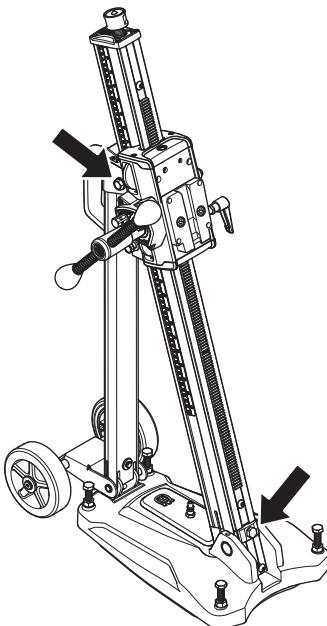
Lösen Sie die Sicherungsschrauben zur Anpassung der Säulenneigung und stellen Sie den gewünschten Bohrwinkel ein. Ziehen Sie die Sicherungsschrauben an. Verwenden Sie den Vorschubgriff. Die Säule kann um 0-60 Grad geneigt werden.
