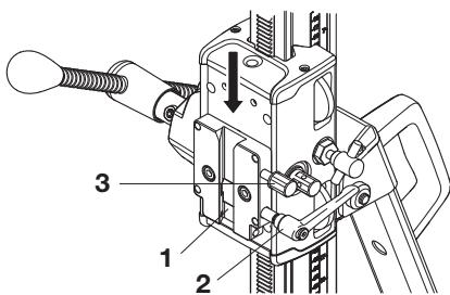
Utilice el tornillo de seguridad superior (3) sólo con DMS 240.
