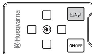
Apkārt esošās sarkanās gaismas diodes norāda, kāda lenķa virzienā ir jāatrodas mašīnai, lai sasniegtu vajadzīgo pozīciju.
