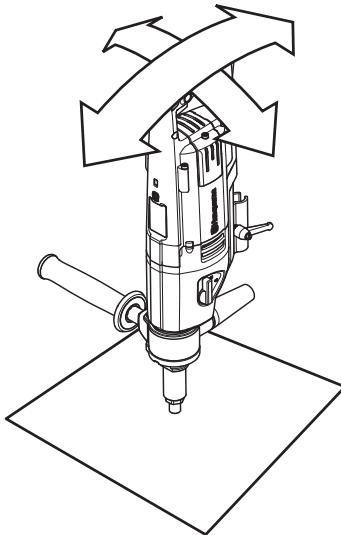
Kui seadme tagakülg on allapoole kaldu, siis keskmise rohelise LED kustub ning esimene punane LED süttib. Kui seadme tagumine külg on ülespoole kaldu, süttib tagumine punane LED.
