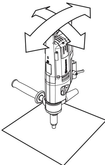
Если задняя часть машины опускается вниз, центральный зеленый светодиод гаснет и загорается передний красный светодиод. Если задняя часть машины поднимается вверх, загорается задний красный светодиод.
